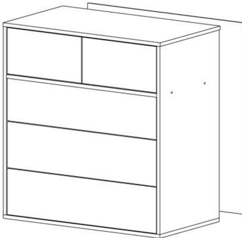
Установка задней стенки осуществляется на гвозди, фронтальная планка цоколя устанавливается на двухсторонний скотч. Задняя стенка устанавливается под крышей комода.
