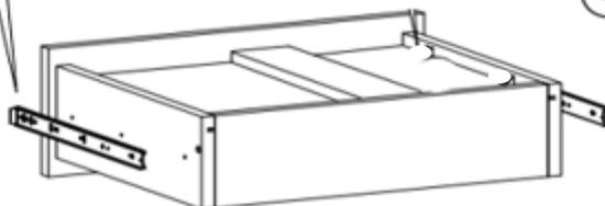
В отдельных случаях, наметки для направляющих могут не совпадать. В этом случае, нужно придерживаться горизонтали, на которой уже есть наметки и установить направляющие вручную.
