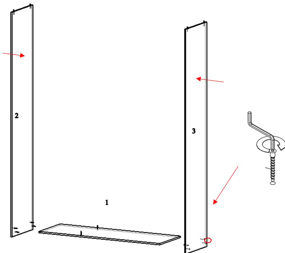
**2. Соединяем крыши шкафов с боковинами и перегородкой.**
